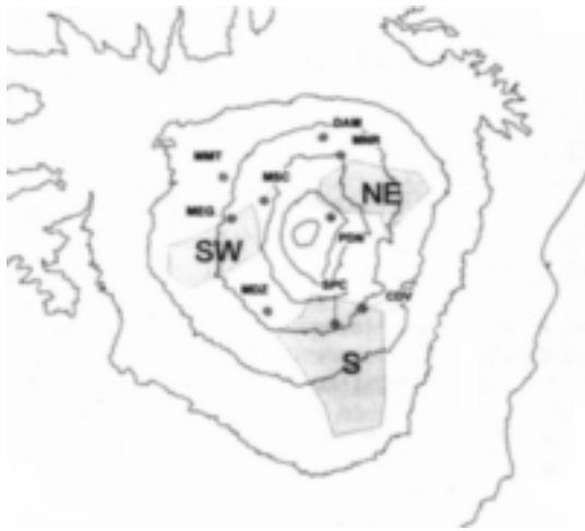
Fig. 7. Disposizione delle stazioni predisposte per la sorveglianza delle deformazioni del suolo nell'area etnea nel 1977 (da Bonaccorso A., Campisi O., Consoli O., Falzone G., Gambino S., Laudari G., Puglisi B., Rossi M., Velardita R., Villari L., 1998).
